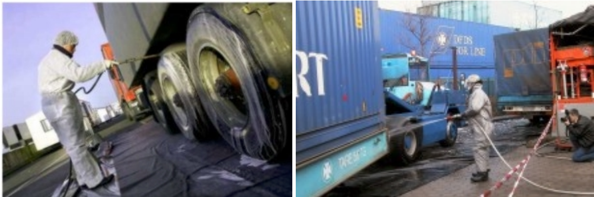
Abb. 3: Ganzflächige Fahrzeugdekontamination im mobilen Sprühverfahren [3], [4]
