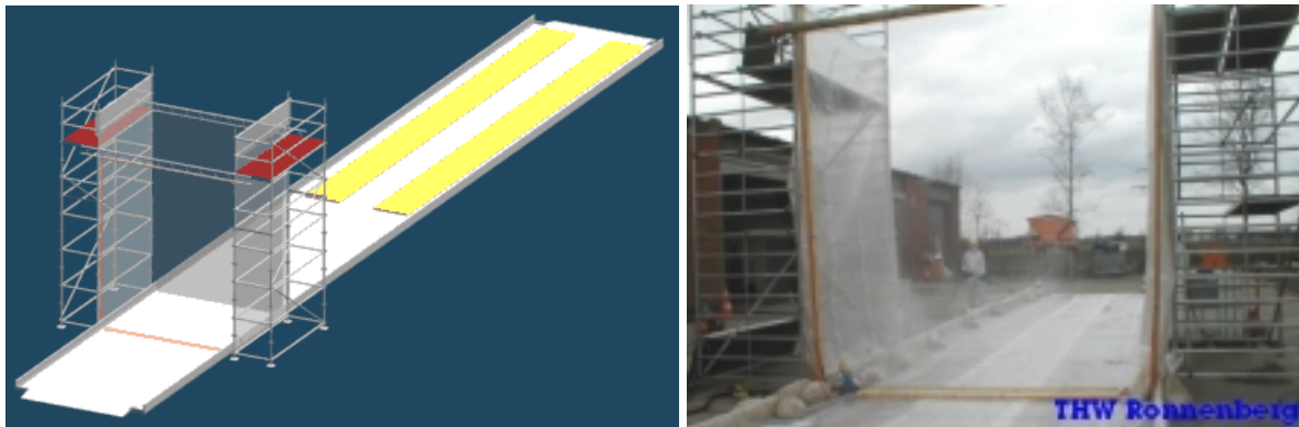
Abbildung 1: Vollflächige Fahrzeugdekontamination mit halbstationären Desinfektionsanlage mit Duscherüst [8]
