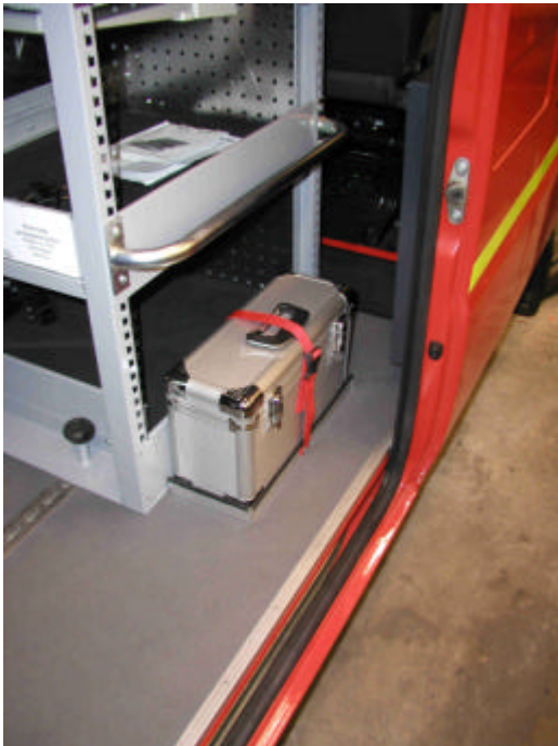
Abb. 16: Lagerung des Messkoffer 1 inkl. Anschluß an 12 V-Stromversorgung.
