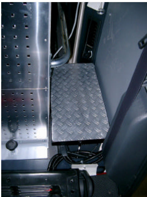
Abb. 14: Eingebaute Gel-Zusatzbatterie neben dem Messcontainer hinter dem Fahrersitz.
