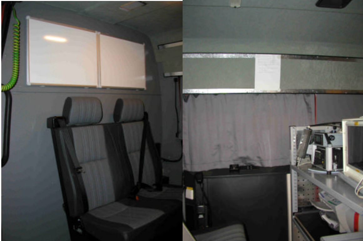
Abb. 1 und 2: Trennwand zum GR hinter der Sitzbank. Dort wurde eine magnetische Wandtafel für Dokumentationszwecke befestigt. Dem gleichen Zweck dienen die beiden angehefteten Metallstreifen über dem linken Fenster.
