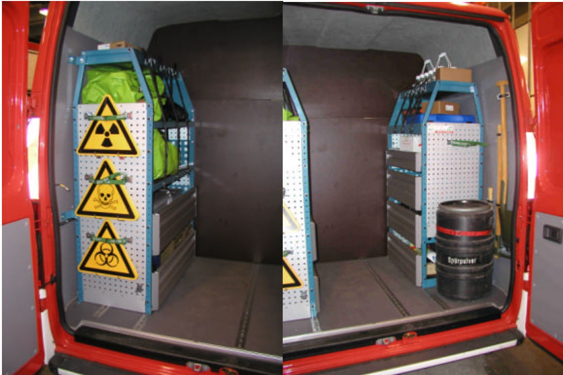
Abb. 5 und 6: Das Kennzeichnungsmaterial und sonstiges Material inkl. der Befestigung für das Faß wurde vom Innenraum nach hinten verlegt.
