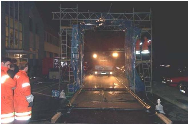
Sprühbalkenanlage im (Übungs-)Betrieb
