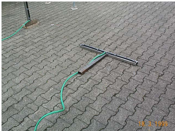
Detailansicht des Sprühbalkens zur Unterbodendesinfektion, Schutz durch Schlauchbrücke
