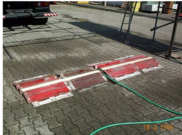
Detailansicht des Sprühbalkens zur Unterbodendesinfektion, Schutz durch Schlauchbrücke
